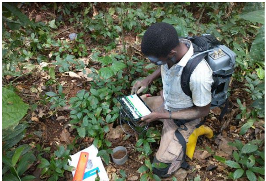
Emmanuel BULONZA en train de mesurer les flux de sol des chambres statiques
